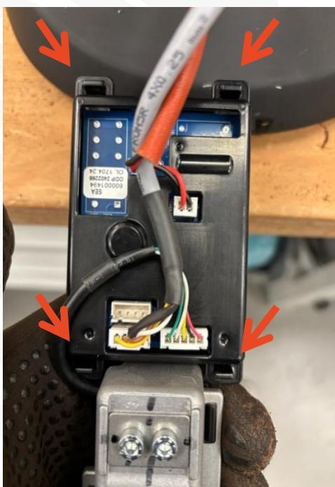
Open up the four clip indicated in **ORANGE** to open up the board socket// Aprire le clip indicate in **ARANCIONE** per poter accedere alla scheda
