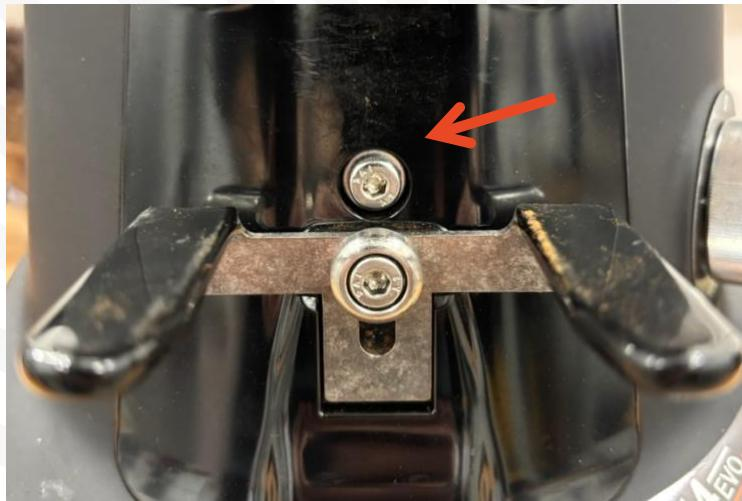
Remove the Hex head screw indicated in order to remove the scale plaque // Rimuovere la vite a brugola per togliere la placca e il supporto portafiltro
