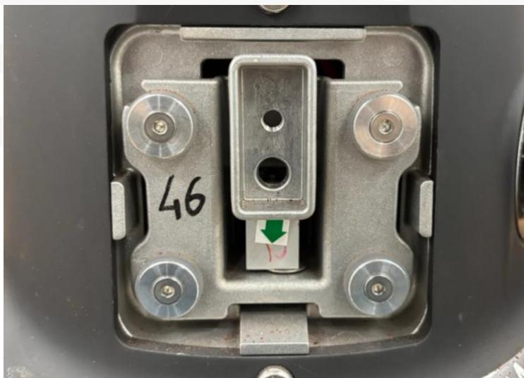
Remove the Hex head screw in order to remove the scale assembly // Rimuovere la vite a brugola per togliere l'assieme bilancia
