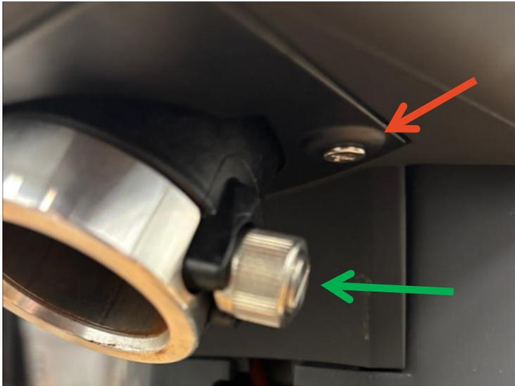
Remove the cylinder by unscrewing the **GREEN** handle and pull it away /// Rimuovere il tubo svitando la manopola in **VERDE** e sfilandolo via
