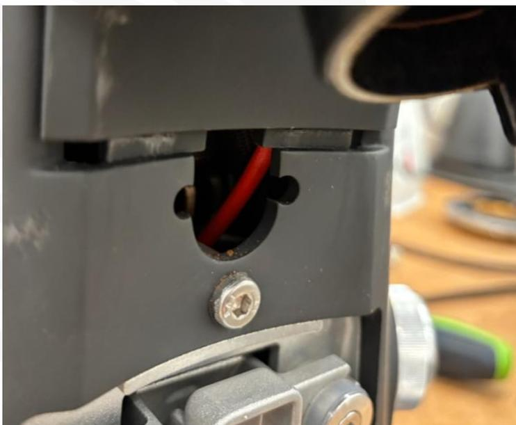
Lift the whole assembly by grab it from the sides and make sure that it will be out of its seat. // Sollevare il cruscotto verso l'alto e farlo uscire dalla sede come in foto.
